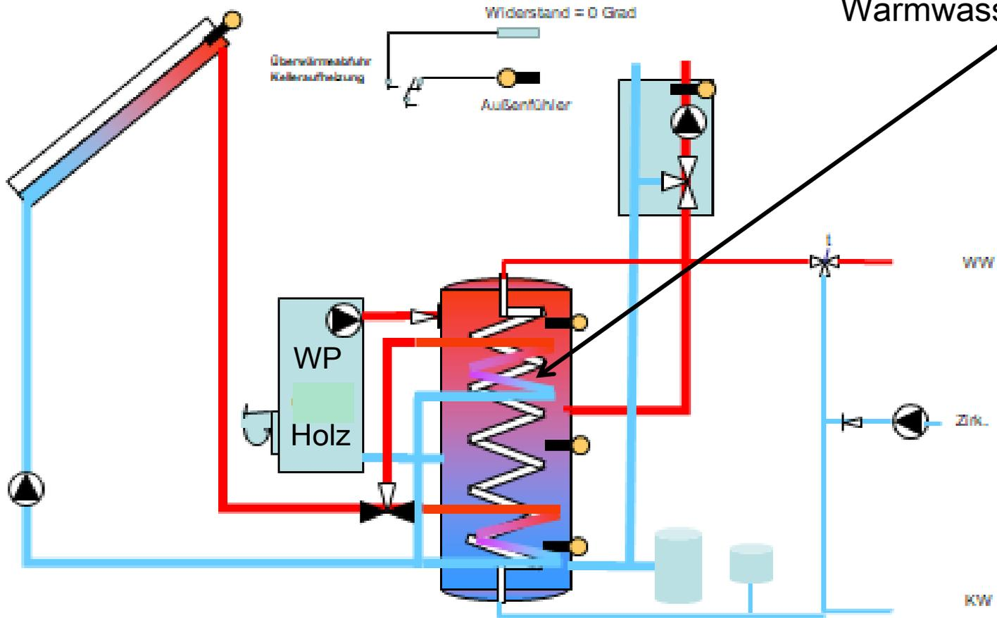
2. Wärmetauscher zur schnellen Aufheizung der Warmwasseranteils
