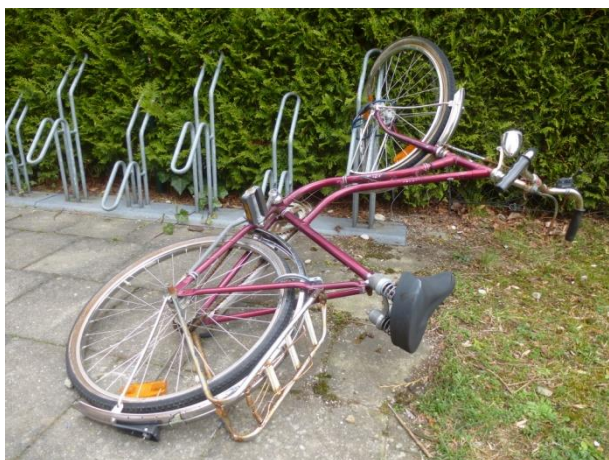
Beispiel einer schlechten Fahrrad-Parkanlage Nur kleiner Teil des Vorderrads wird fixiert, das Fahrrad steht unsicher und kann kippen.
